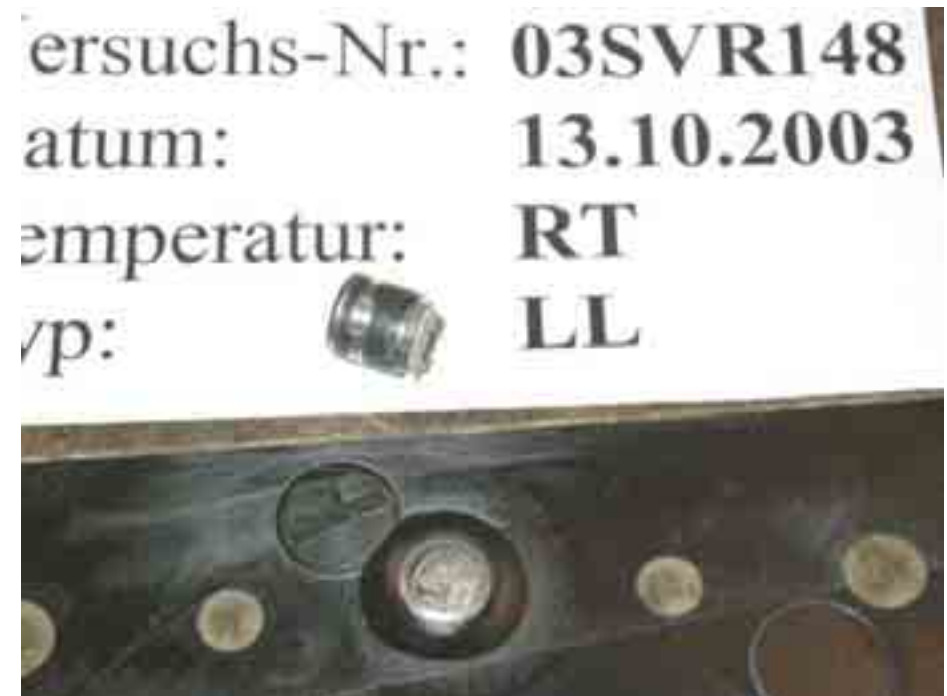
Mittlerer Befestigungsdom für Airbagmodulgehäuse ausgebrochen
